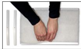
7. Bevestig voorzichtig de filter in de filterhouder en zorg ervoor dat het filter aansluit bij alle punten van de houder.
