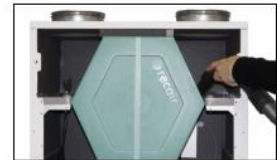
4. Het is raadzaam om met een stofzuiger de ruimtes waar de filters zitten te reinigen van mogelijk aanwezig vuil of stof.
